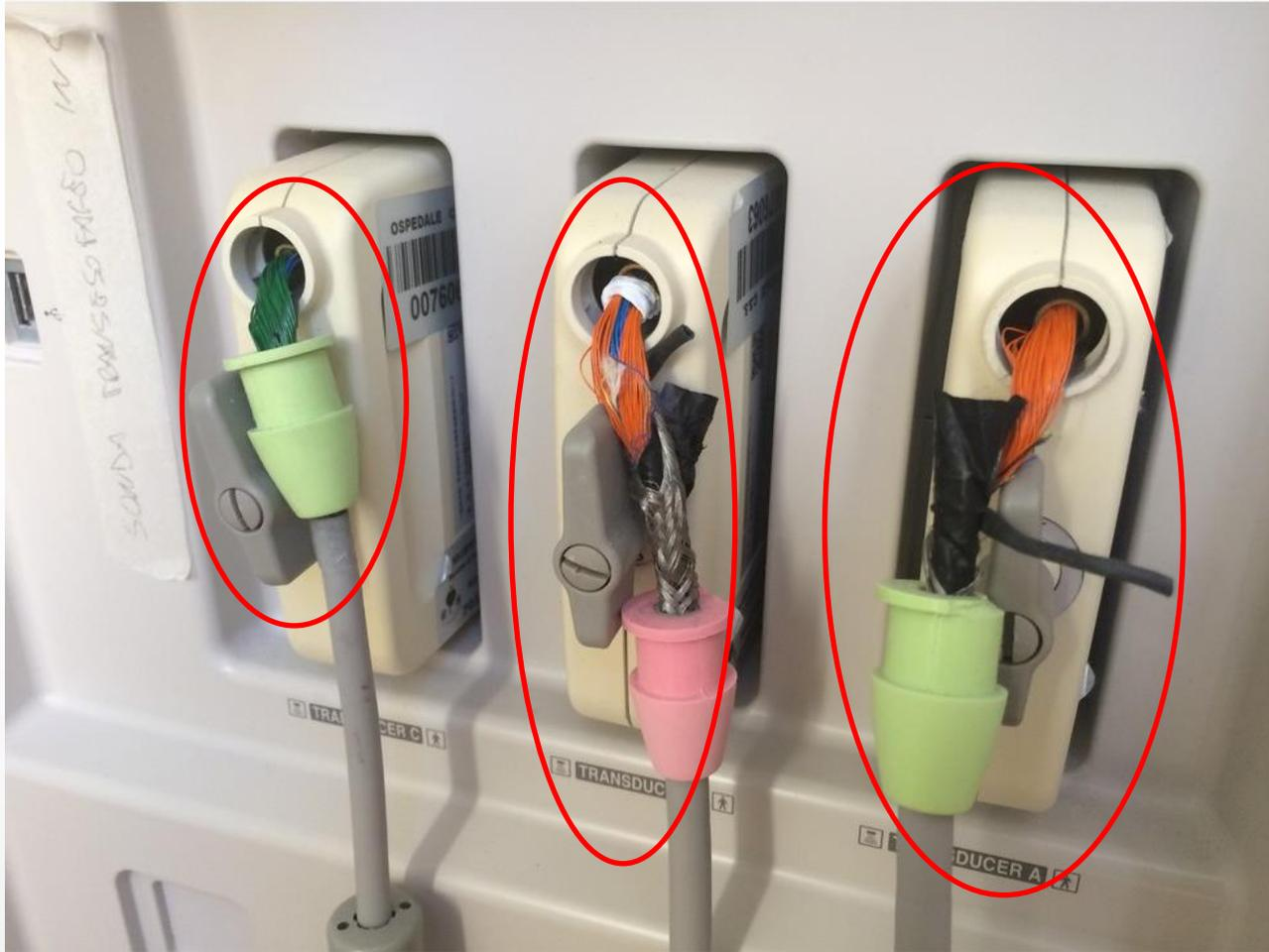
La tensione del cavo della sonda può portare ai seguenti esiti.
