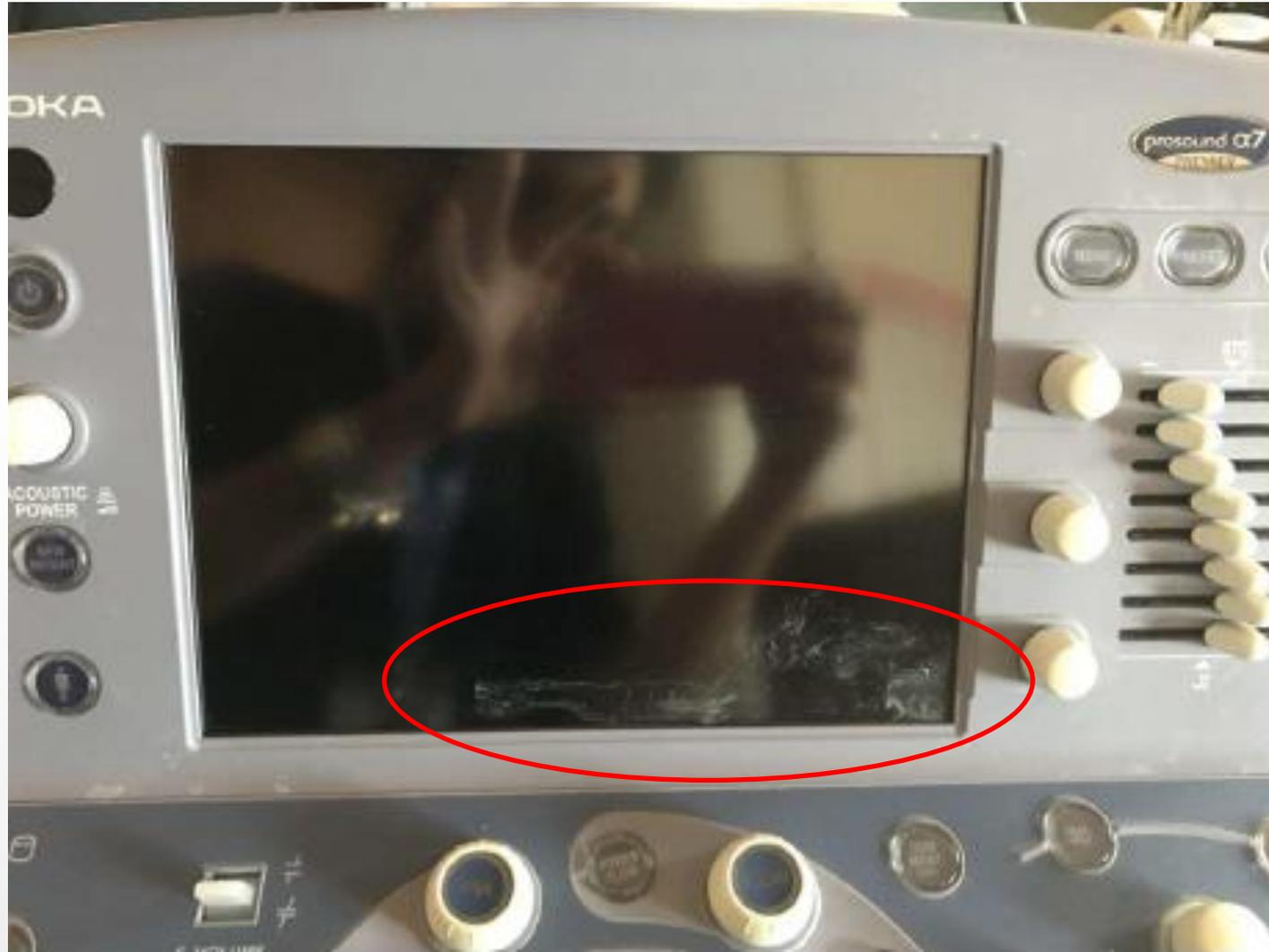
Touch screen di un monitor infiltrato a seguito di una procedura di pulizia non adeguata.
