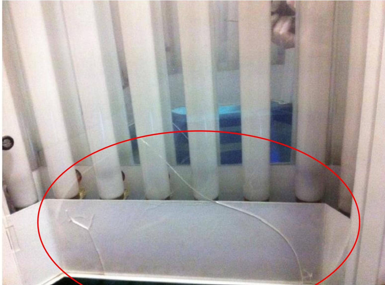
A seguito di urto si è stata danneggiata la protezione interna laterale destra.
