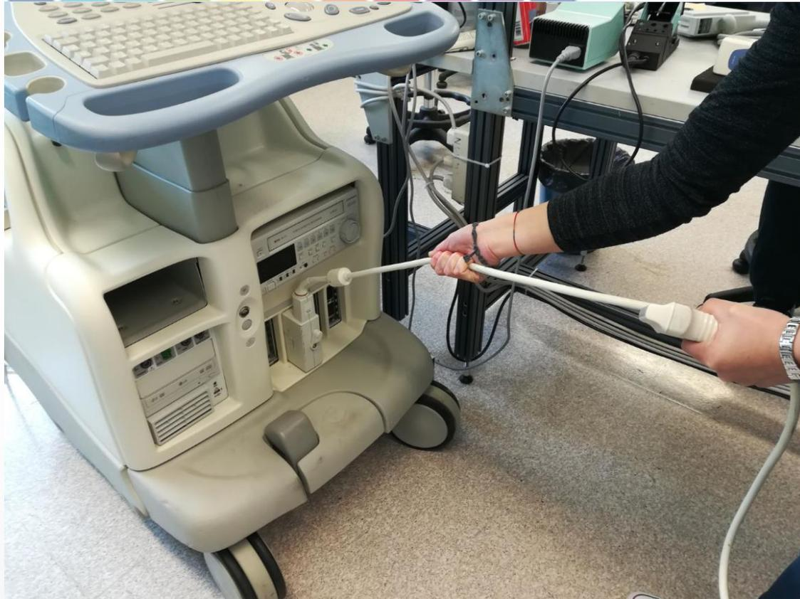
Il cavo delle sonde non è una maniglia, ed un'azione anche involontaria porta al risultato sottostante.
