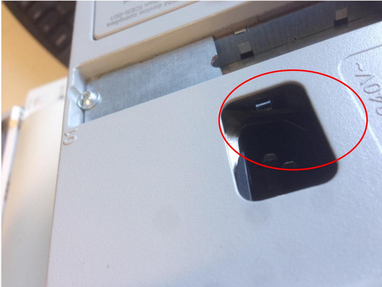
Forzatura del connettore del cavo separabile di rete.
