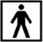
Parte applicata di **tipo CF**: garantiscono un alto grado di protezione ed hanno parte applicata flottante.
