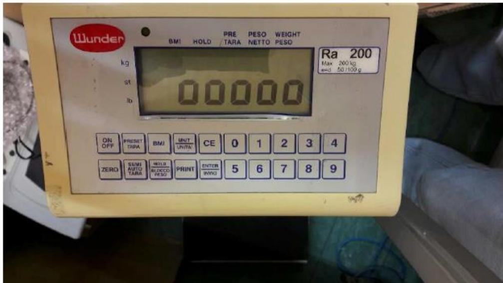
Membrana display danneggiata, rimane bloccata impedendo l'accesso al service a causa del danneggiamento per flessione della scheda interna.
