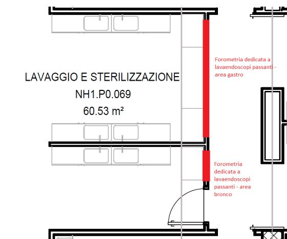
**Figura 5: Area in cui è prevista l'installazione di lavaendoscopi passanti.**
